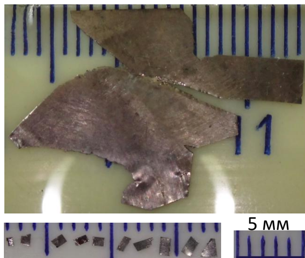
Рисунок 3.2. Титановый «лепесток» и отрезанные от него частицы-включения для одного опыта.
